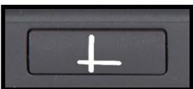
Durch das Drücken der Hilfslinien/Bildschirmabdeckung-Taste (zweite Taste von links) wechseln Sie den Modus zwischen Linieneinblendung, Bildschirmabdeckung oder der Vollbilddarstellung nacheinander. Die Hilfslinien können Ihnen das Lesen von Texten oder das Schreiben auf der Vorlage erleichtern. Die Bildschirmabdeckung kann benutzt werden wenn Sie die großflächige Helligkeit des Bildschirms stört oder Sie sich nur auf ein bis zwei Textzeilen konzentrieren möchten.
