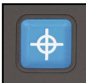
按住蓝色的正方形概览按钮三秒钟就会激活一个红色的 LED，这个红色的灯光照射在阅读板上。这个阅读位置指示器会帮助你定位摄像头所处在阅读板上的位置。例如：在写字时，将笔放置在阅读台的红点上，笔就会显示在屏幕的中央。再次按下此按键，就会关闭 LED 灯。大约 30 秒之后，阅读指示器的功能也将自动关闭。
