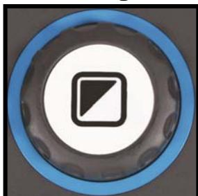
Individuare la ghiera dello Zoom al centro del Controller. Ruotare la ghiera in senso orario per aumentare l'ingrandimento e in senso antiorario per diminuirlo.
