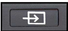
Ist eine externe Quelle, z. B. ein Computer, an den ClearView C angeschlossen, betätigen Sie die Pfeilsymbol-Taste (zweite Taste von rechts) um zwischen dem ClearView C- Bild und dem Vollbild des Computers umzuschalten.
