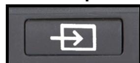
Si un ordenador u otro dispositivo está conectado al ClearView C, presione el botón **PC** gris que es el segundo botón del lado derecho, marcado con una flecha, para alternar entre las imágenes del ClearView C y del ordenador en modo a pantalla completa.
