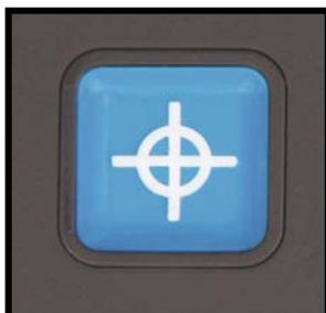
De overzicht functie zorgt voor een overzicht over de tekst, om te bepalen waar er gelezen moet worden. Druk op de vierkante blauwe knop bovenop het bedieningspaneel om deze functie te activeren.
