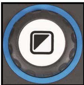
位于控制板中间位置的选择按键。顺时针方向旋转，是增加放大倍率；逆时针方向旋转是减少放大倍率。
