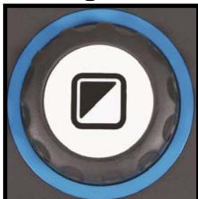
Drehen Sie den Vergrößerungsregler, um sich durch die Menüpunkte zu bewegen. Drücken Sie den weißen Modetaster in der Mitte des Vergrößerungsreglers zum Aktivieren des ausgewählten Menüpunktes oder zur Bestätigung der Auswahl.
