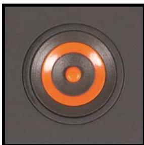
Um das System und den Bildschirm einzuschalten, drücken Sie die runde orange Ein/Aus-Taste neben dem Vergrößerungsregler auf der Bedieneinheit. Der ClearView C startet in dem gleichen Modus in dem Sie ihn beim letzten Male ausgeschaltet haben.
