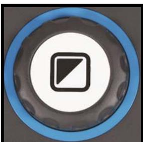
Al presionar el botón **Mode** (Modo) ubicado en el centro de la rueda del zoom le permitirá recorrer de dos a cinco modos de visualización, dependiente de la configuración de su sistema:
