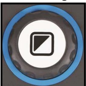
Um die Vorlagenbeleuchtung auszuschalten drücken Sie den weißen Modustaster vier Sekunden lang. Dies dient zur Vermeidung von Lichtreflektionen bei glänzenden Vorlagen. Mit weiterem Drücken der Taste schalten Sie zur nächsten Lesefarbe mit wiederkehrender Beleuchtung. Halten Sie die Taste für vier Sekunden, so wird nur die Beleuchtung ohne Wechsel der Lesefarbe eingeschaltet.
