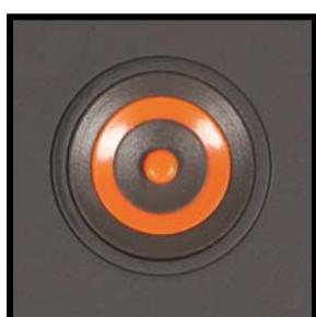
按住位于控制板上放大旋钮旁边的橙色的圆形按键, 即可打开系统和显示器的电源。ClearView C 将会启动, 显示的图像模式就是上一次关机时的图像模式。
