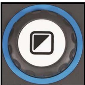
Appuyez sur le bouton "Mode" au centre du bouton-cadran "Zoom" pour sélectionner entre deux ou jusqu'à cinq modes de visualisation. Le nombre de modes de visualisation dépend de la configuration du système.
