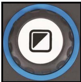
Benutzen Sie bitte den Vergrößerungs-Drehregler in der Mitte der Bedieneinheit. Durch das Drehen nach rechts erhöhen Sie die Vergrößerung, durch das Drehen nach links reduzieren Sie die Vergrößerung.
