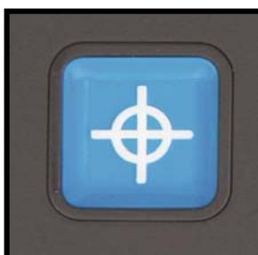
Premendo il pulsante quadrato blu per tre secondi si attiva un puntatore rosso a LED sul piano di lettura. Il puntatore consente di individuare il punto dove la telecamera sta puntando. Quando si scrive, se si posiziona ad esempio una penna sull'indicatore luminoso rosso, si vedrà la penna visualizzata al centro dello schermo. Premere ancora una volta il pulsante per spegnere la luce a LED.
